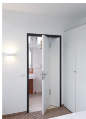
86 – 89 Mit Raumpartüren können Bewegungsflächen für Rollstuhlfahrerinnen und -fahrer sowie Nutzerinnen und Nutzer von Rollatoren minimiert werden. Eine frontale Durchfahrt ist von beiden Seiten möglich.
